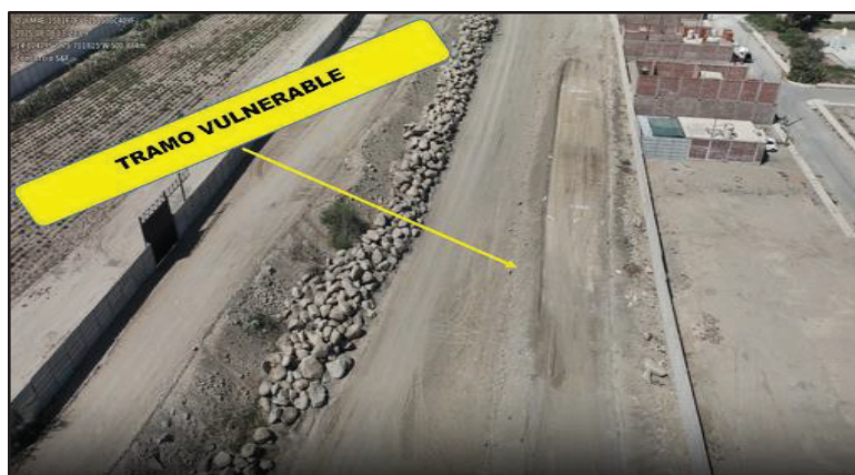
FOTOGRAFIA 01: Tramo 2 crítico en la Quebrada Cansas Para Limpieza Y descolmatacion en una longitud de 100.00 ml
