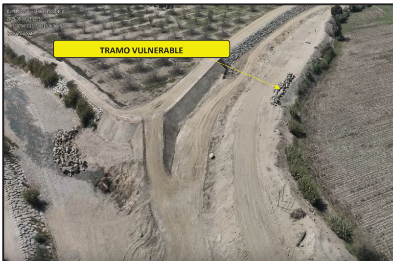
FOTOGRAFIA 02: Tramo 1 crítico en la Margen Izquierda de la quebrada Cansas para limpieza y descolmatacion en 400.00 ml y construccion de dique enrocado en 380.00 ml.
